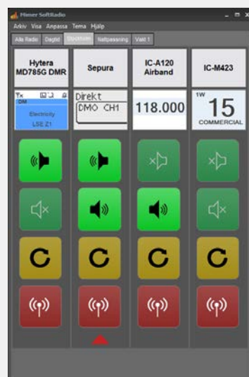
Mimer SoftRadio med flera olika radiotyper inkopplade
